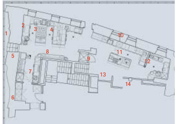
1 Kühl- und Trockenlager 2 Arbeitsplatz Saucier/Poissonier 3 Herdanlage (Design Eibach) 4 Arbeitsplätze Entremetier, Gardemanger, Pâtissier 5 Bankett mit Kombitechnik (Design Eibach) 6 Service Bankett 7 Arbeitsplatz Bankett Anrichte 8 Service à la carte 9 Aufzug 10 Arbeitsplatz Glace, Getränke- und Gläserchränke 11 Buffet 12 Spülanlage 13 Zentralkasse 14 Zugang Restaurant
